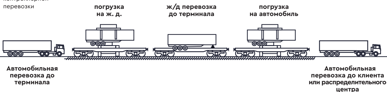
Рисунок 47. Схема организации контейнерной перевозки
