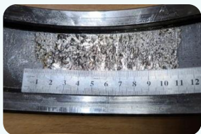
Выкрашивание металла с поверхности катания
